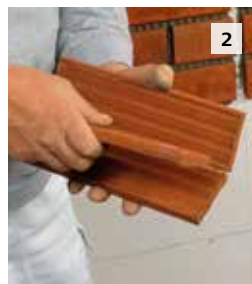
240x71x d Normalni format (Normalformat - NF)
