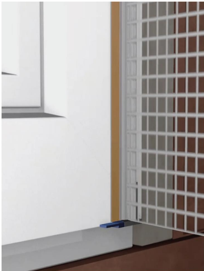
sl. 2: StoProfile Drainage – pozicioniranje ispod priključnog profila
