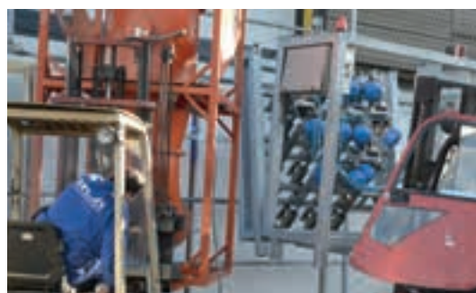
Windmaschine, Beregnung und Massenhagel – der Versuchsaufbau in Graz
