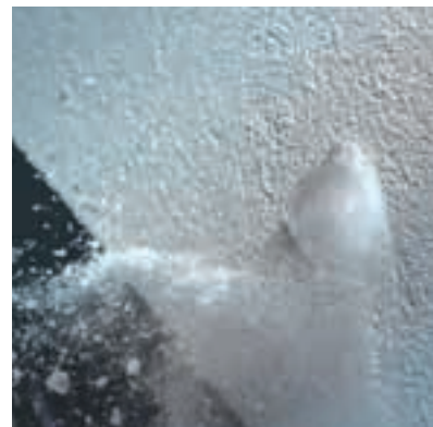
Aufnahme Hochgeschwindigkeitskamera - das WDVS hält dem Hagelschauer stand.
